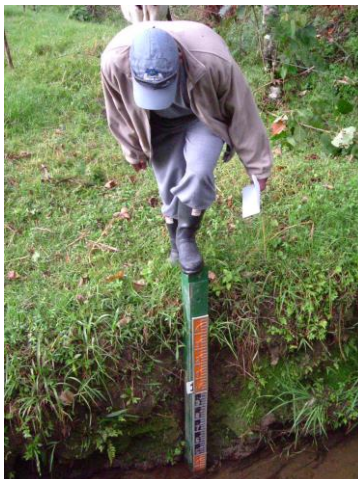
Toma de Lectura en Estación Limnimétrica La Mosquita, en Quebrada del mismo nombre.
