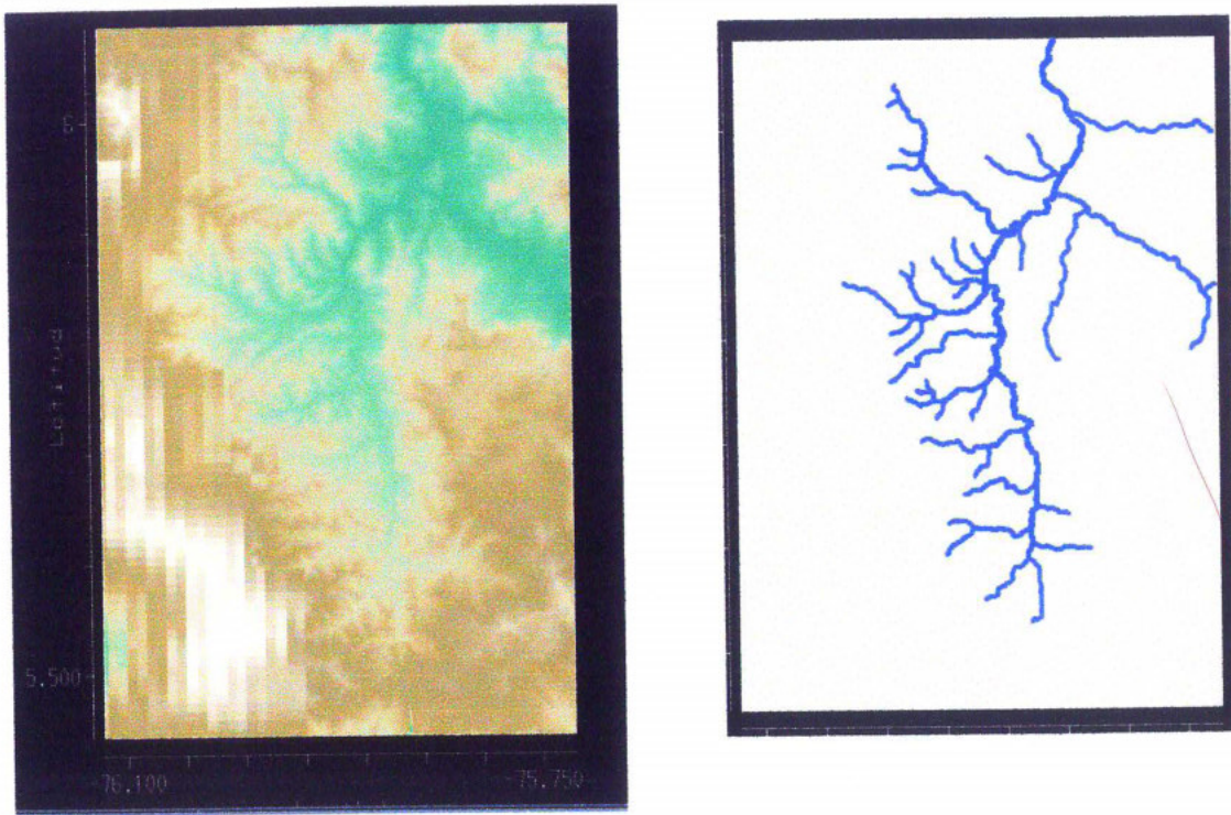
Figura 5.9. Modelos Digitales de Terreno resultantes y líneas azules rasterizadas para el Valle del río San Juan.
